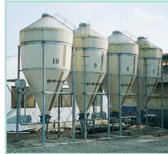
CK/WK-50給餌ライン（飼料タンク2連×2台） 飼料タンク2基取りの2ラインシステムです。前期、後期の飼料をそれぞれ反対方向から搬送し、豚舎内の豚房の飼育日令に合わせた給餌を行っています。
