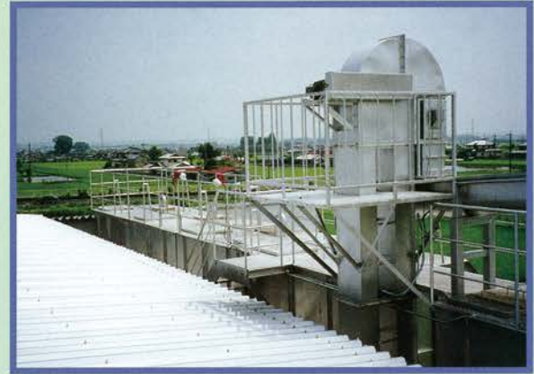
●攪拌し、製品化された飼料をバケットコンベアーで製品タンク上部に搬送
