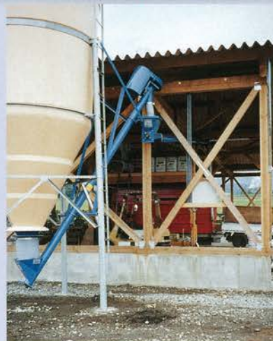
●スクリュコンベアー (SC-140) を中継して牛舎内に飼料搬送
