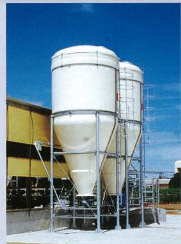
●ケーブルコンベアー (K-50) で牛舎内に飼料搬送
