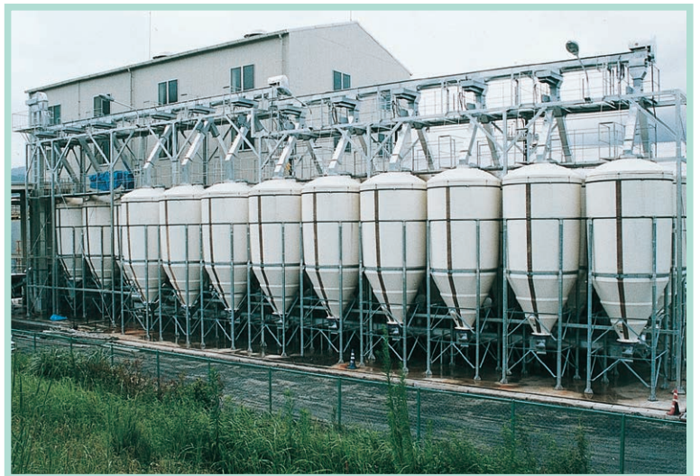
飼料タンク (20基) へ Uトラフスクリューで飼料搬送 (エア駆動のシャッターと二股ダンパー付き)
