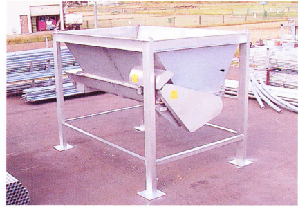
搬送スクリューは ● 塗装 ● 一部SUS ● オールSUS いずれも可能です。
